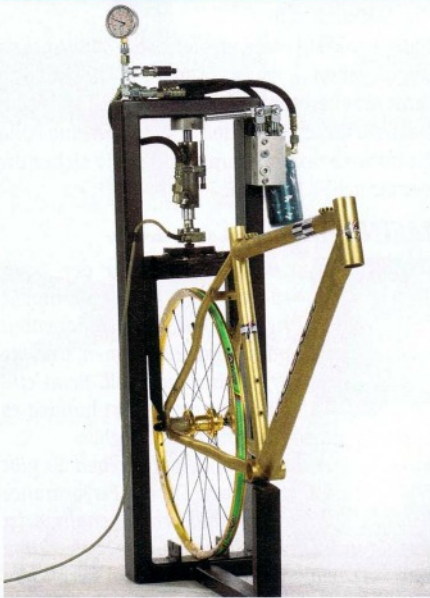
Mit diesem von Theo Piele entwickelten Prüfgerät wird das Laufrad über die Radachse auf den Boden gedrückt, um so die Fahrbelastung zu simulieren. Dann wird jede Speiche einzeln vermessen.
